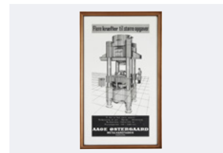
Den nye Banning-presse trykker 3.000 t og bruges bl.a. til skærebord til grønthøstere.
