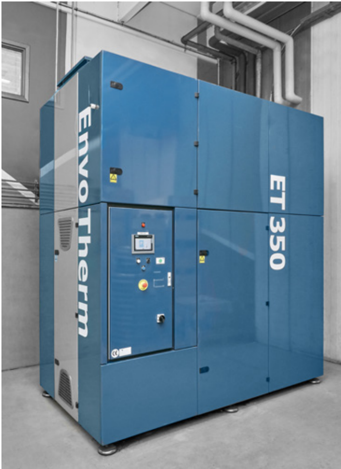
På dette anlæg inddampes alt skyllevand fra SP's vaskemaskiner. Dvs. alt vandet kan genanvendes og der bortskaffes udelukkende urenhederne fra vaskeprocessen.
