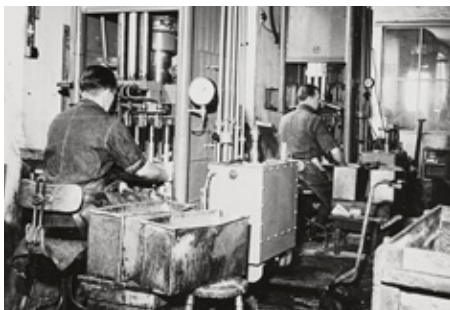
Trækning af bælge til Danfoss' radiator-ventiler.
